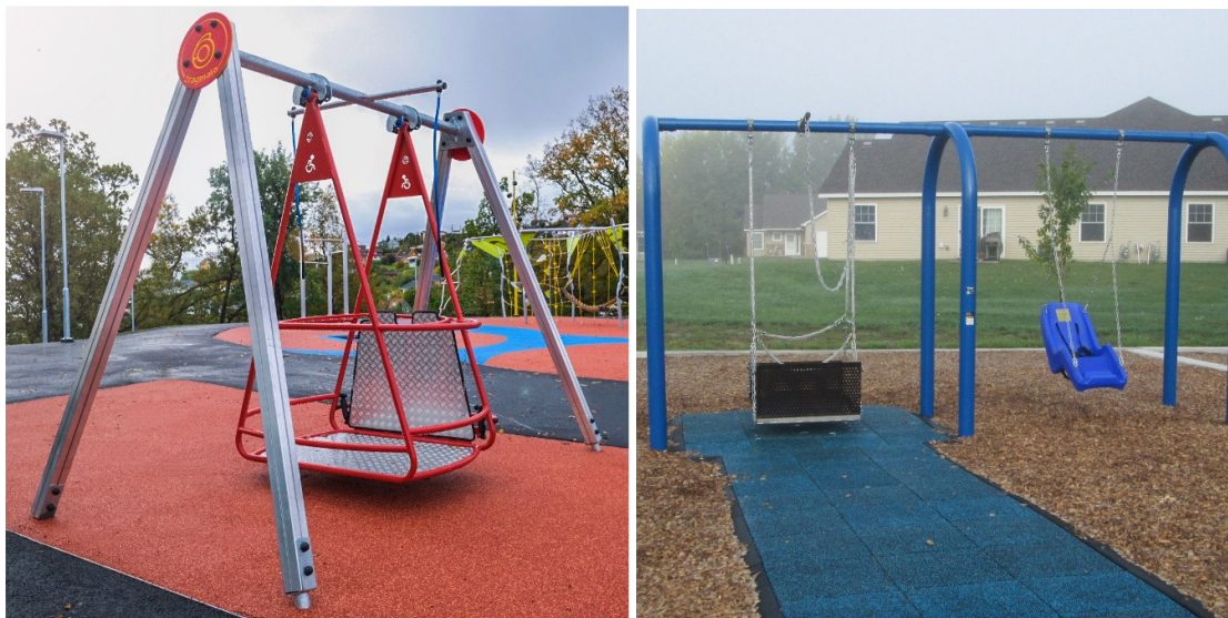
Foto 7. Sobiva konstruktsiooni ja kujundusega ratastooli kiik. Foto 8. Kummiplaatidest ligipääsurada - oranžid või tumepruunid plaadid.
