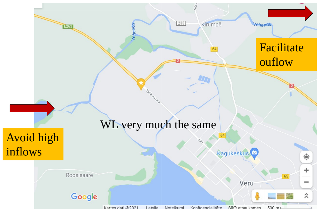
Joonis 7.1. Üleujutusohu vähendamise põhimõtteline skeem.
