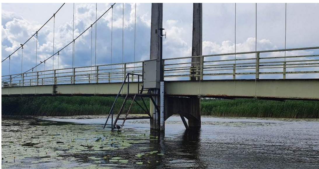
Joonis 3.2.25. Tamula järve veetaseme mõõtmise andur Roosisaare sillal.
