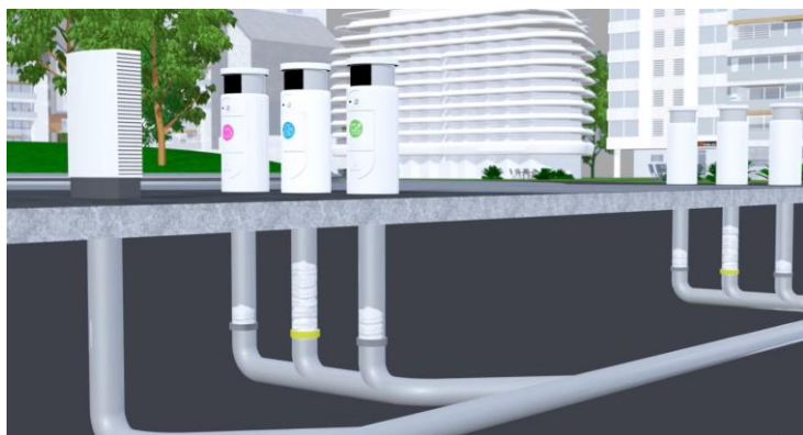
Joonis 29. Pneumaatiline jäätmekogumissüsteem (kuvatõmmis videost https://www.envacgroup.com/how-it-works/ ).
