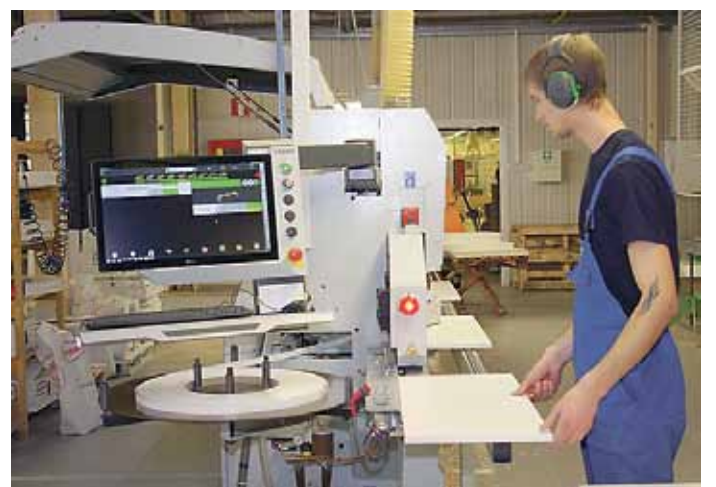
ASis Wermo on moodne tehnika, pildil on töös täisautomaatne servapealistusseade ehk kandimasin.
